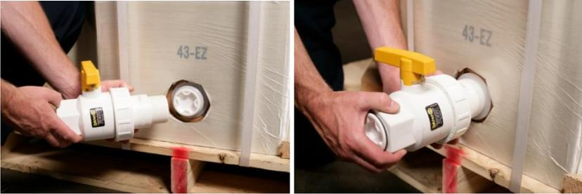
Retire el "tapón de rosca de 2" de la pestaña de 2" de la bolsa y adjunte la válvula en el accesorio de evacuación inferior de 2".
