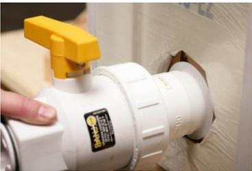
Ensarte el ensamble de la válvula grado alimenticio en la parte inferior del accesorio de evacuación. **NOTA: Es muy importante insertar el conjunto de la válvula hasta el fondo para asegurarse de que la junta tórica está ajustado y sellado contra el accesorio de evacuación.**
